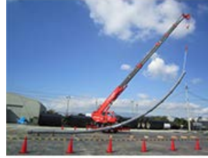
抗震型球墨铸铁管 G X形 口径 400
