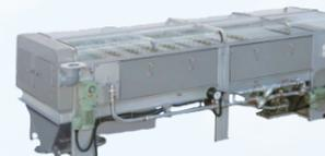
污水处理设施用机器 带式过滤浓缩机 (SNM-02X~15X)
