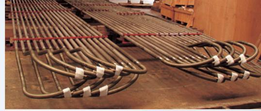
用于乙烯成套装置的反应管
