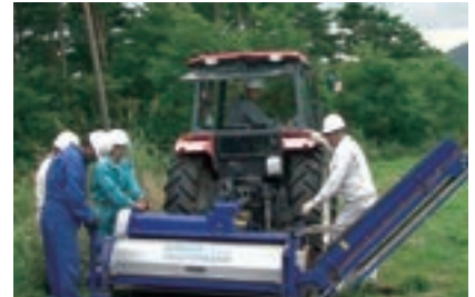
用于洪水期间排水 排水泵发动机 (泰国)
