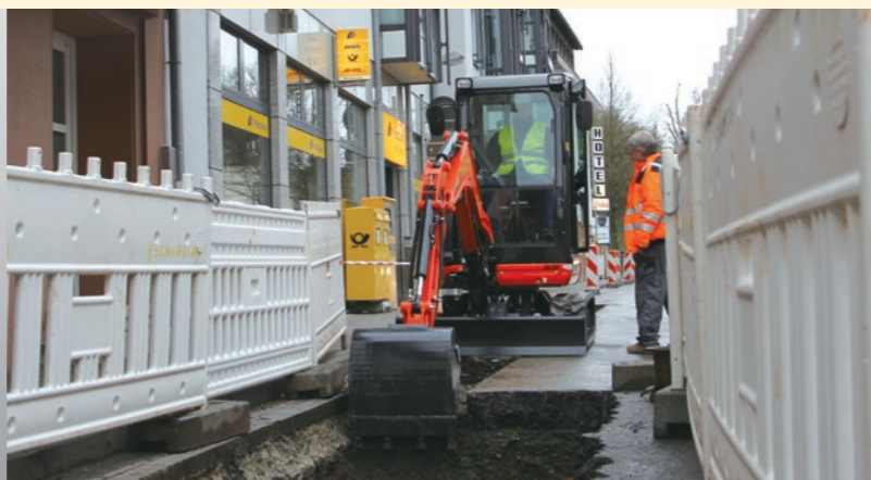
小型挖掘机 进行土木施工等。特别适合于街道等狭窄的场所。
