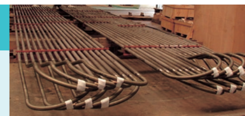
铸钢 用于乙烯精炼等石油化工成套设备。
