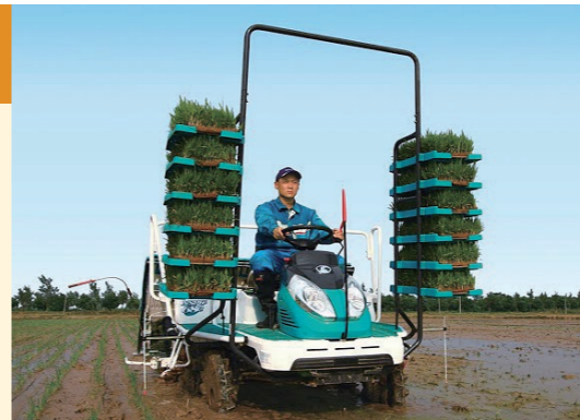
插秧机 将水稻秧苗转插至水田。可大幅节省人力、减轻劳动强度。
