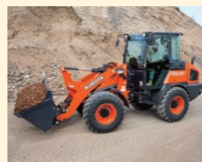
轮式装载机 主要在施工现场或农场用于搬运和装载作业。
